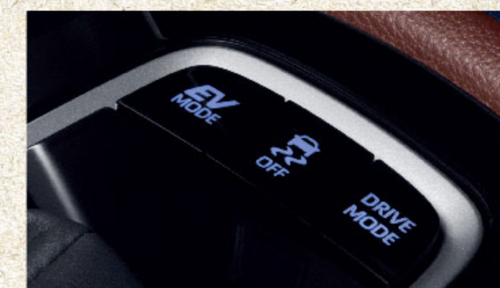
EV MODE ใช้กำลังจากมอเตอร์ไฟฟ้าเพื่อการเดินทางที่เงียบสนิ SPORT MODE เพิ่มสมรรถนะในการขับขี่ และตอบสนองอัตราเร่งได้ดียิ่งขึ้น ECO MODE ช่วยลดการใช้พลังงานที่สิ้นเปลือง เพื่อการใช้พลังงานอย่างมีประสิทธิภาพ
